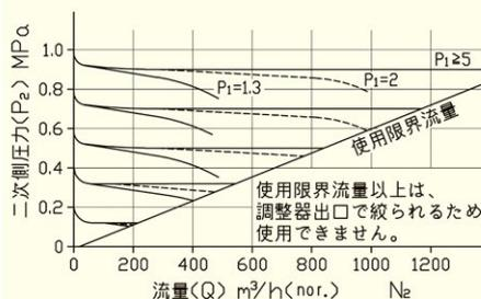
NPR-5B 圧力変動曲線
