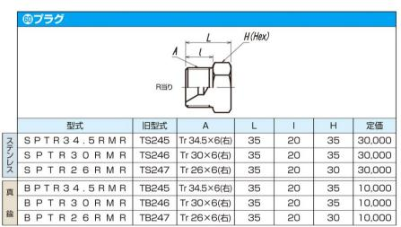
標準納期通常在庫品〜受注後2週間 最高使用圧力 20MPa対応です。20MPaを超える圧力の場合はご相談下さい。 (型式により低圧仕様のものがあります。)
