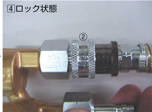
①を指で固定し、②を矢印の方向に廻して、ロックします。
