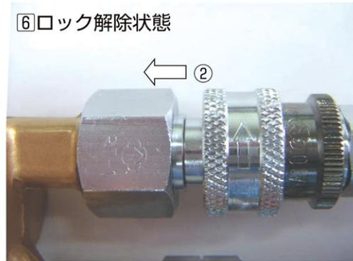
①を指で固定し、②を矢印と逆方向に廻して、ロックを解除します。
