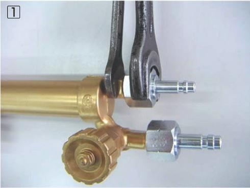
① プラグを工具で吹管・調整器に取り付けします。
