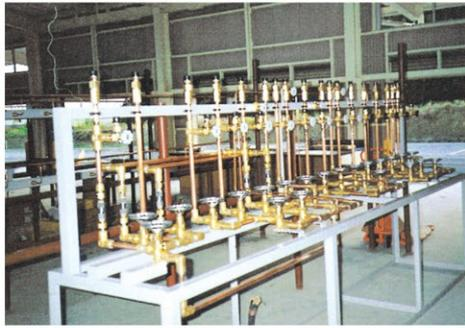
各種ガス充填設備架台
