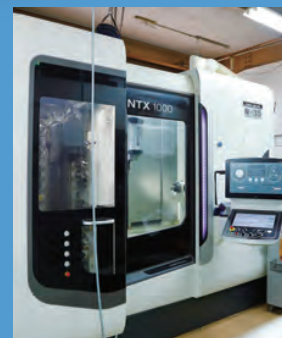
複合加工機 (NC旋盤) 複雑な形状の部品 を高精度に加工す ることが可能。主に 圧力調整器の本体 を加工しています。
